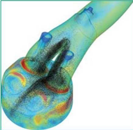
Fig 2: Simulazione del flusso turbolento interno ad un motore di automobile (Courtesy: STAR-CD, CFD Technology, CD Adapco Group)
