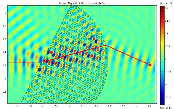
Fig.2 Elementi ottici diffrattivi: rifrazione di un'onda elettromagnetica da parte di un reticolo di allumina
