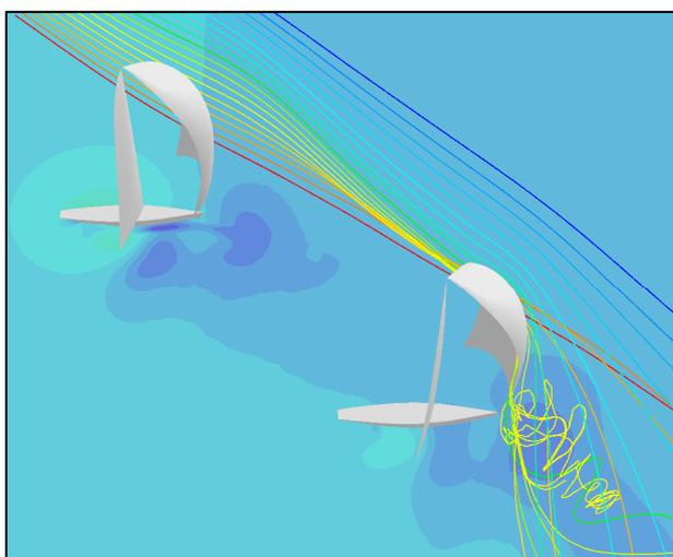
Fig. 7 Linee di flusso dell'aria fra due barche a vela da competizione in assetto da gara
